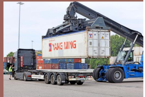
Vom Containerzug (oben) werden die Großraumbehälter für die letzte Meile auf den Lkw geladen.
