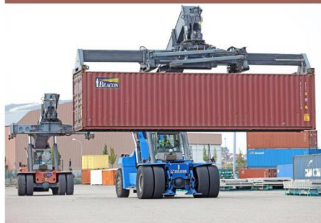
Das Gewicht eines 40-Fuß-Containers beträgt bis zu 30 Tonnen, für den Reachstacker kein Problem. Fotos: Ralf Seidel
